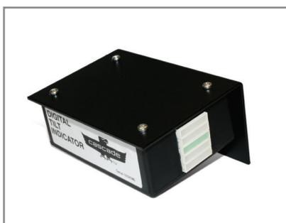
チルトインジケータはマストの垂直位置 確認に役立ちます。視覚的に、マストが前傾、後傾、垂直位置にあることをお知らせします。センサー感度は、1° 以内と正確です。マストの角度を常時わかりやすい表示でお知らせすることにより、予想作業を無くし、パレットへのダメージを減少させ、効率とスピードを向上させます。
