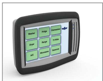
簡単操作でクランプ力をコントロールし、様々な荷役作業における製品へのダメージ低減を実現するタッチパネル式のデバイスです。カートクランプをはじめ、ロールクランプやレイヤーピッカ等、クランプ力調整が必要となるあらゆるアタッチメントに有効です。あらかじめ設定した積荷情報に応じて荷を選択すると、設定されたクランプ力に調整されます。
