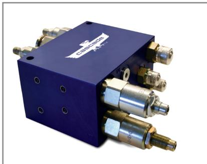
油圧比例弁式クランプ力調整ユニットは、ロール紙の重量により変化するマストシリンダ油圧に合わせてクランプシリンダの油圧を自動調整するユニットです。これにより、過剰なクランプによるロール紙への損傷を防止します。また最適なクランプ力の調整が可能で、オペレータによる操作は不要です。
