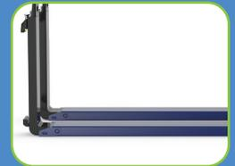
薄いフォーク厚で薄いポケットのパレットに対応するモデルもラインナップ
