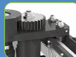
ラックとピニオン間の公差を調整し、スムーズな 操作を可能にする偏心ピン採用
