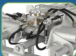
アタッチメントと荷物/地面との位置調節を可能にする水平調整ネジ
