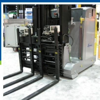
代表的なAGV用アタッチメントであるカートンクランプ、ペーパーロールクランプ、マルチロードハンドラーをはじめ、幅広いAGV用アタッチメントをご提案いたします。
