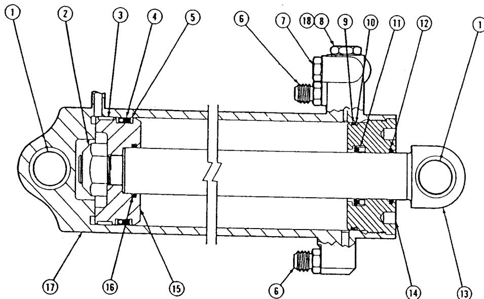
**警告：油圧ホースを外す前に、システム内の油圧を抜きます。リフトトラックを止め、操作レバーを両方向に数回動かして下さい。**
