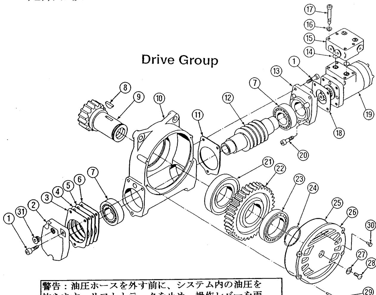
**警告 :**油圧ホースを外す前に、システム内の油圧を抜きます。リフトトラックを止め、操作レバーを両方向に数回動かして下さい。
