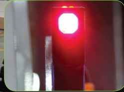
光センサを作動させ、適切なクランプ位置を検出
