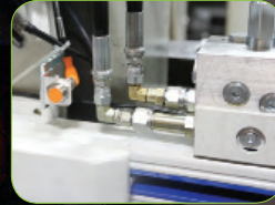
GPIO 油圧バルブで回路切替え。(インプット、アウトプット各2個)
