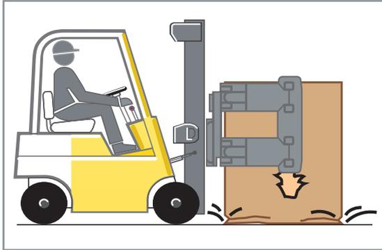
荷を持ち上げている時に、誤ってレバー操作し、クランプを解除してしまうことを防ぎます。このシステムでは、オペレータがボタンを押した場合にアームが開くよう設定されています。またオペレータへは、ランプ点灯によりアームオープンが可能であることを知らせる仕組みになっており、荷へのダメージを防ぐだけでなく、安全かつ安心して荷役作業が行えます。
