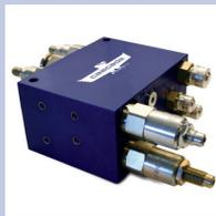
油圧比例弁式クランプ力調整ユニット(HFC)は、ロール重量により変化するマストシリンダ油圧に合わせてクランプシリンダの油圧を自動調整するユニットです。
