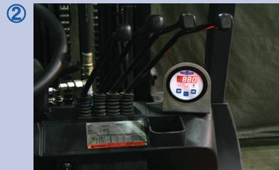
無線方式の圧力信号伝達の為、マストへの配線施工が不要となり、簡単に取付けできます。
